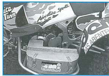
Die solide Leichtmetall-Box für Werkzeug, Ersatzteile und Notsender ist gleichzeitig auch Schutz für die Füße des Fahrers
