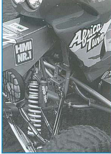
Vorderbau mit White-Power-Federbein nach PKW-Vorbild
