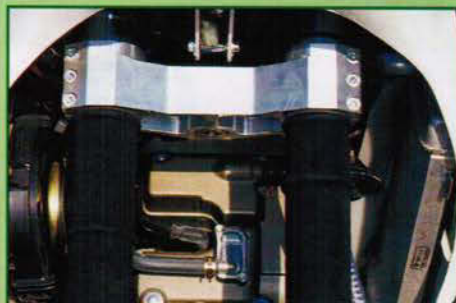
Dreifach-Klemmung an der unteren Gabelbrücke
