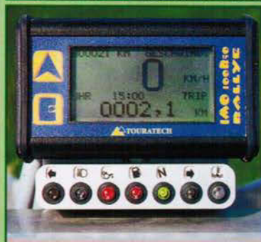
Rallye-Instrumentarium und ausreichend Kontrollleuchten
