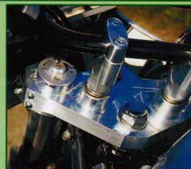
Aus dem Vollen gefräste Gabelbrücken, Lenkererhöhung
