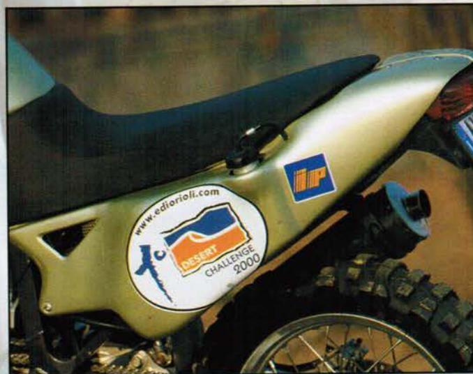
In alto, Roberto Boano posa con la Transalp. Sopra, primo piano di uno dei due serbatoio carburante ricavati posteriormente ai lati della sella. A lato, la tecnologica strumentazione. Nella dotazione un trip computer multifunzionale Touratech e un GPS Garmin.
