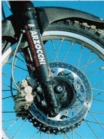
Starke Nissin Zweischeiben-Bremsanlage.
