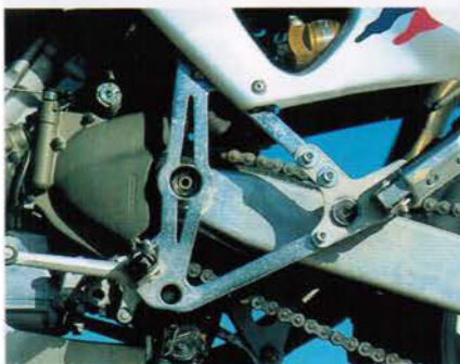
Stabile Ausführung: Fußrastenhalter.
