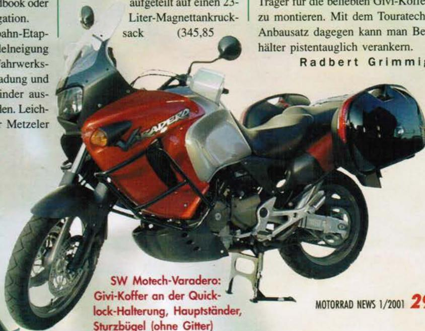
**SW Motech-Varadero: Givi-Koffer an der Quicklock-Halterung, Hauptständer, Sturzbügel (ohne Gitter)**
