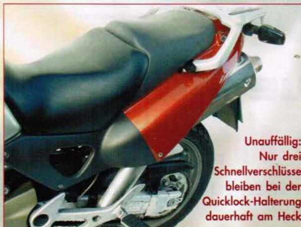
Unauffällig: Nur drei Schnellverschlüsse bleiben bei der Quicklock-Halterung dauerhaft am Heck
