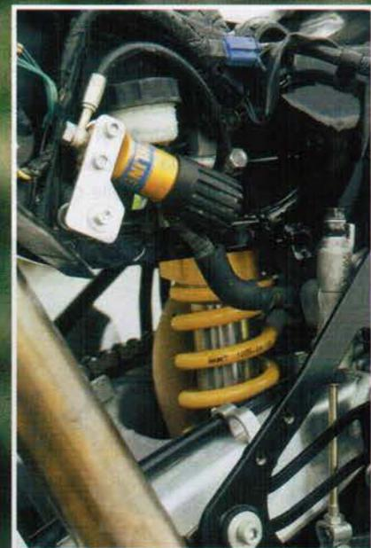
In alto, la completissima strumentazione per "navigare", completa di road book e tripmaster. Nell'altra foto, l'ammortizzatore Ohlins completamente regolabile con, in primo piano, il pomello per la regolazione idraulica del precarico molla.
