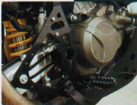
Qui sopra, l'ampia piastra alleggerita serve da protezione alla pompa freno, da supporto allo scarico speciale e da paracolpi di parte del forcellone in alluminio.
