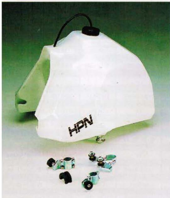
BMW-Spezialist HPN baut für die Zweiventil-GS-Reihe von BMW diesen 43-l-Tank aus Polyamid oder Polyethylen.
