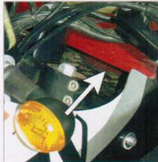
Von vorn völlig offener Luftfilterkasten
