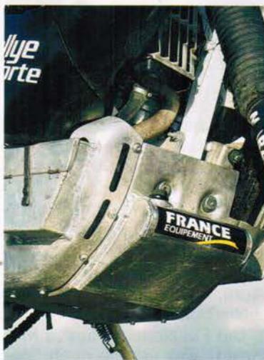
Vorn am Motor Wassertank, seitlich Werkzeugkästen
