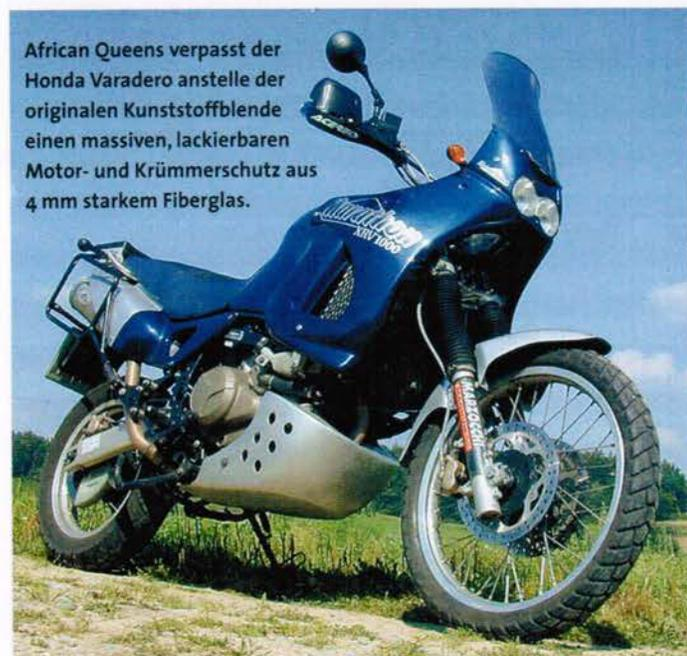
African Queens verpasst der Honda Varadero anstelle der originalen Kunststoffblende einen massiven, lackierbaren Motor- und Krümmerschutzh aus 4 mm starkem Fiberglas.
