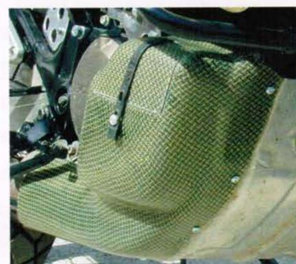
Für Wasser oder Werkzeug: Die Alu-Seitenteile von Desertstorm für den Original-Motorschutz der Africa Twin integrieren zwei kleine Wassertanks (oben). Das Carbon/Kevlar-Seitenteil mit Werkzeugfach stammt von African Queens und kann auch als Pärchen bzw. inklusive Mittelteil geordert werden (links).
