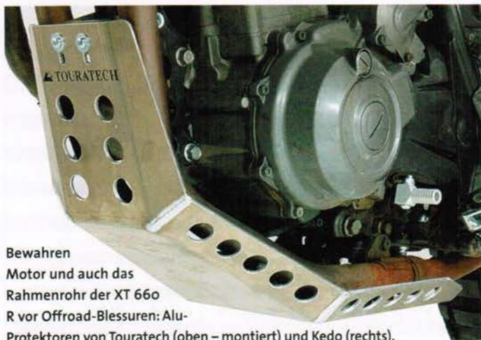
Bewahren Motor und auch das Rahmenrohr der XT 660 R vor Offroad-Blessuren: Alu-Protektoren von Touratech (oben – montiert) und Kedo (rechts).
