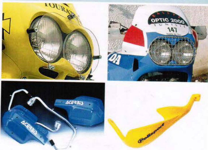
Plexiglasschutz für den Scheinwerfer von Touratech und Metallgitter von African Queens (unten). Aufwendige Handschützer mit Metallbügeln von HPN, einfache Ausführung komplett aus Kunststoff erhältlich bei Götz (ganz unten).
