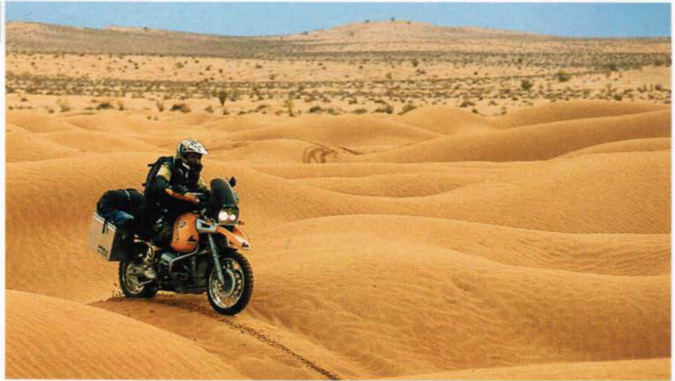
Das Anfahren ist auf Sand das Schwierigste. Einmal in Fahrt werden die Gänge schnell hochgeschaltet, das Motorrad wird mit dem Gas immer auf Zug gehalten.
