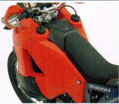
African Queens bietet Großtanks für verschiedene Modelle an. Als Werkstoff dient meist GFK. Zwei Tankhälften aus schlagzähem Kunststoff von Touratech verhelfen der KTM 950/990 Adventure zu einem Kraftstoffvorrat von 45 Litern. Die seitlich am Tank der BMW R 1200 GS montierten Tanks stammen von Touratech. Damit sind insgesamt 36 Liter Sprit an Bord. Der Klassiker für alle GS-Modelle mit Zweiventil-Motor: der 43 Liter fassende Tank von HPN.
