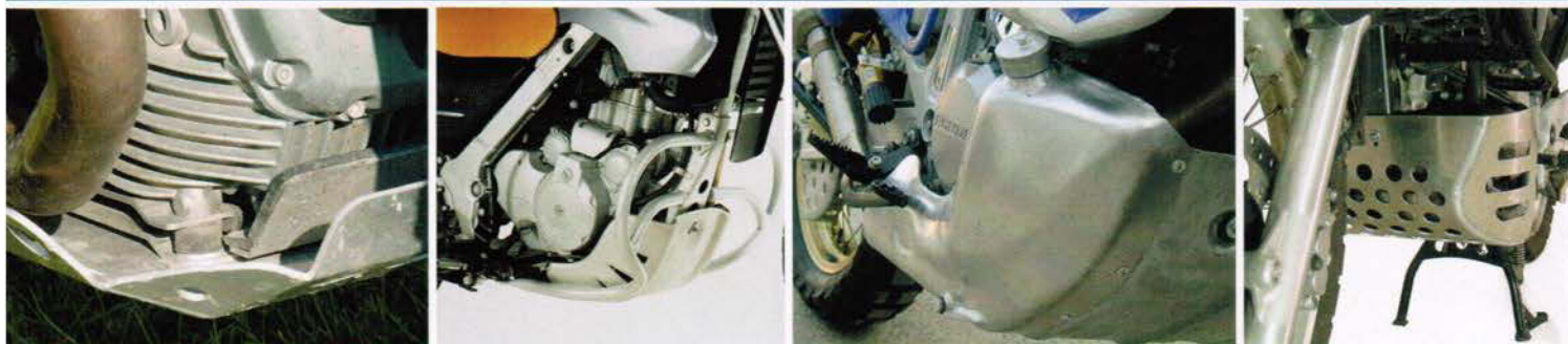
Der Motorschutz von Touratech für die R 1200 GS verfügt über dämpfende Gummielemente.
