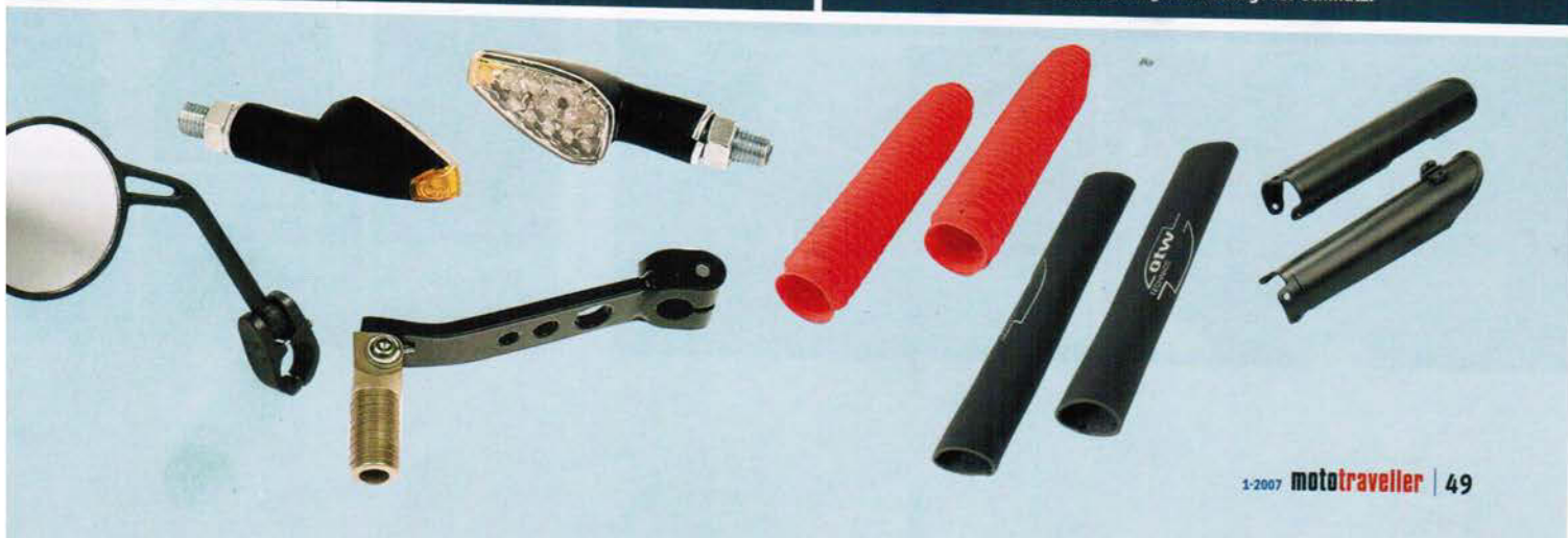
Faltenbälge empfehlen sich zum Schutz konventioneller Gabeln. Bei Upside-Down-Gabeln kommen vorzugsweise Neoprenhüllen oder Kunststoffschienen zum Einsatz, letztere schützen allerdings nur bedingt vor Schmutz.
