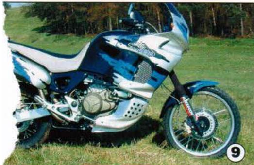
9. Für die Honda Varadero fertigt African Queens einen großflächigen, 4 Millimeter starken Alu-Schutz, hier montiert am hauseigenen Twindero-Umbau.
